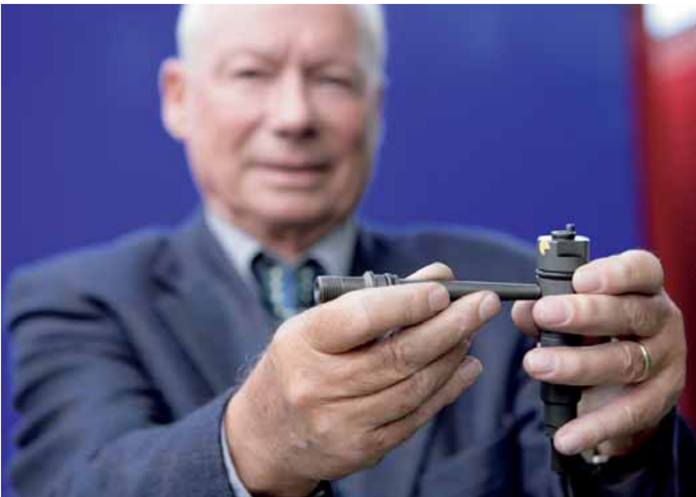
Die Einspritzdüse ist das Herzstück des Actros-Motors. Das System ist auf höchste Effizienz bei Druckverhältnissen bis 1.800 Bar ausgerichtet
